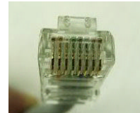
全電線が先端から 見えている事を確認 しながら圧着
